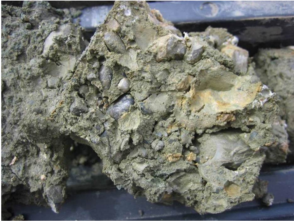
Figura 60 – Depositi fluviali (Qt1d) in sondaggio (5b-SD12 34.50 m)
