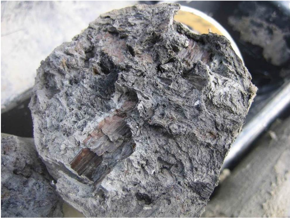
Fig. 44 – Depositi lagunari (H1a) in sondaggio (5b-SD24 / 9 m)
