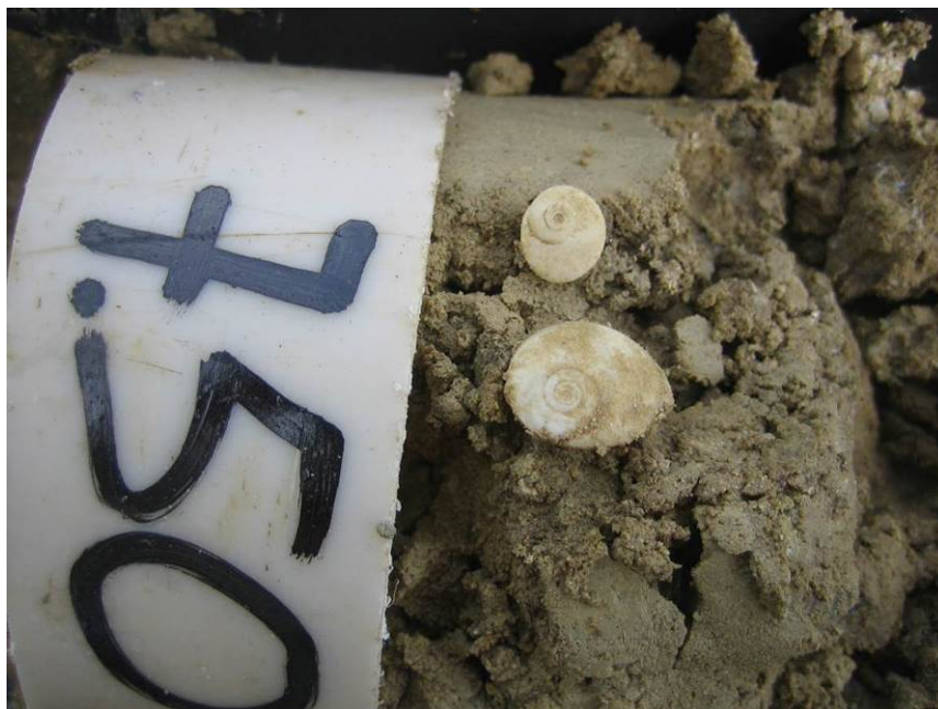
Fig. 53 – Depositi di spiaggia (H3c) in sondaggio (5b-SD16 / 7.50 m)
