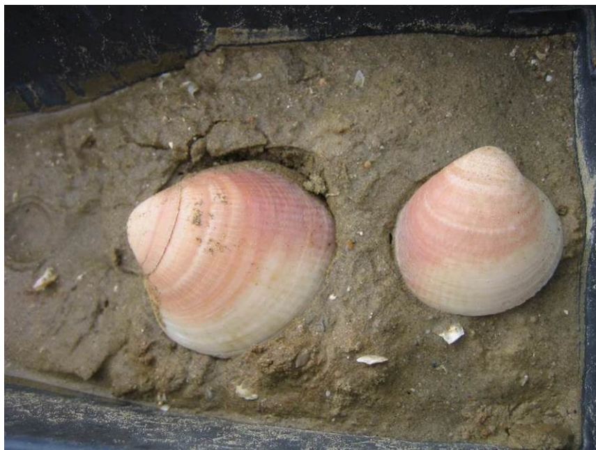
Fig. 50 – Depositi di spiaggia (H3c) in sondaggio (5b-SD15 / 11.0 m)
