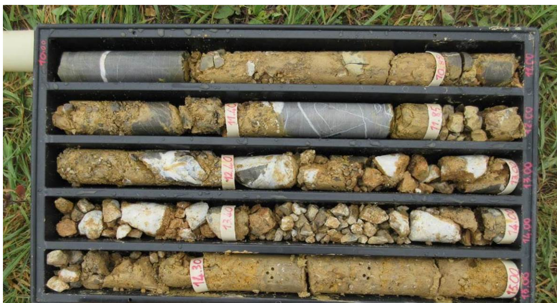
Fig. 71 – Argille e calcari di Canetolo (ACCa) in sondaggio (SD4 10 - 15 m)
