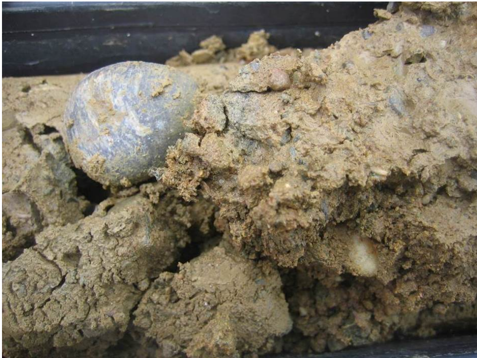
Figura 61 – Depositi fluviali (Qt1d) in sondaggio (5b-SD12 39.80 m)
