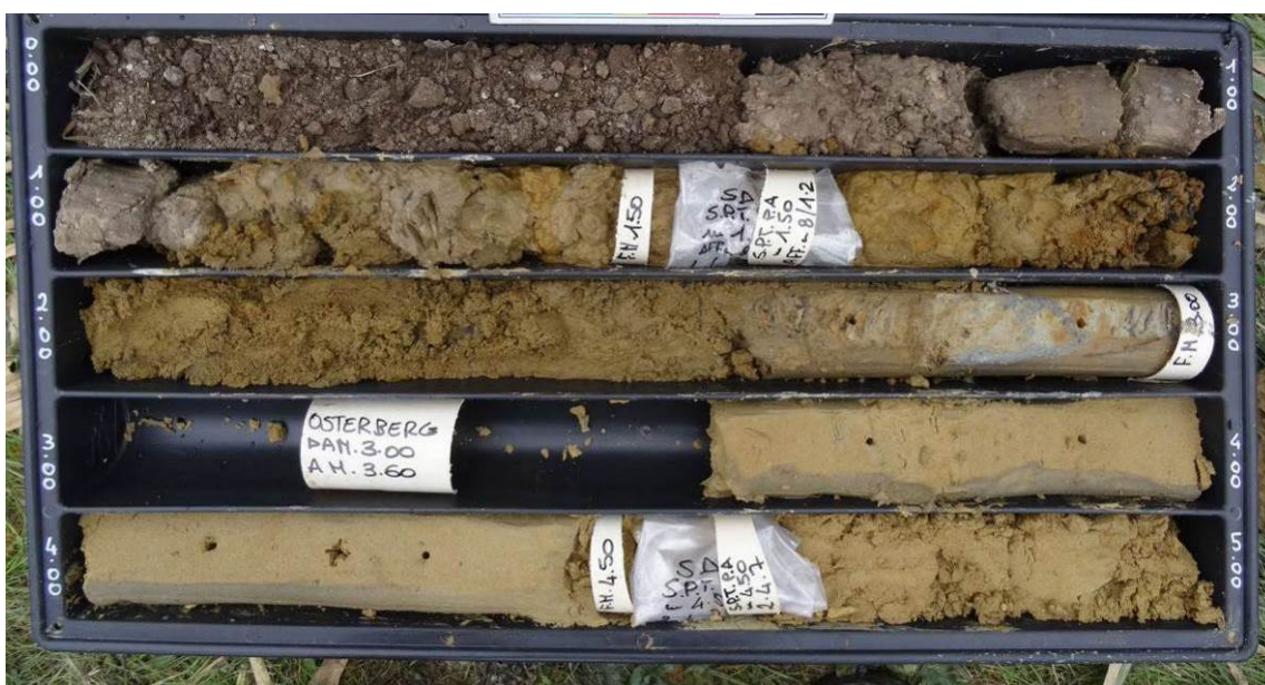
Fig. 42– Depositi di ambiente marino (H1a2) in sondaggio (5b-SD29 1.20-5 m)
