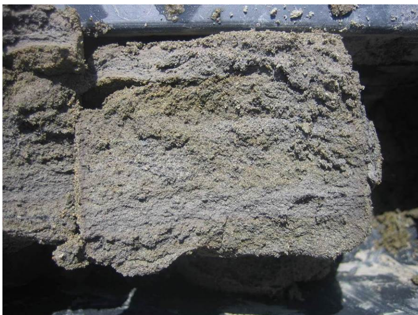
Fig. 54 – Depositi di ambiente deltizio (H3b) in sondaggio (5b-SD20 m)
