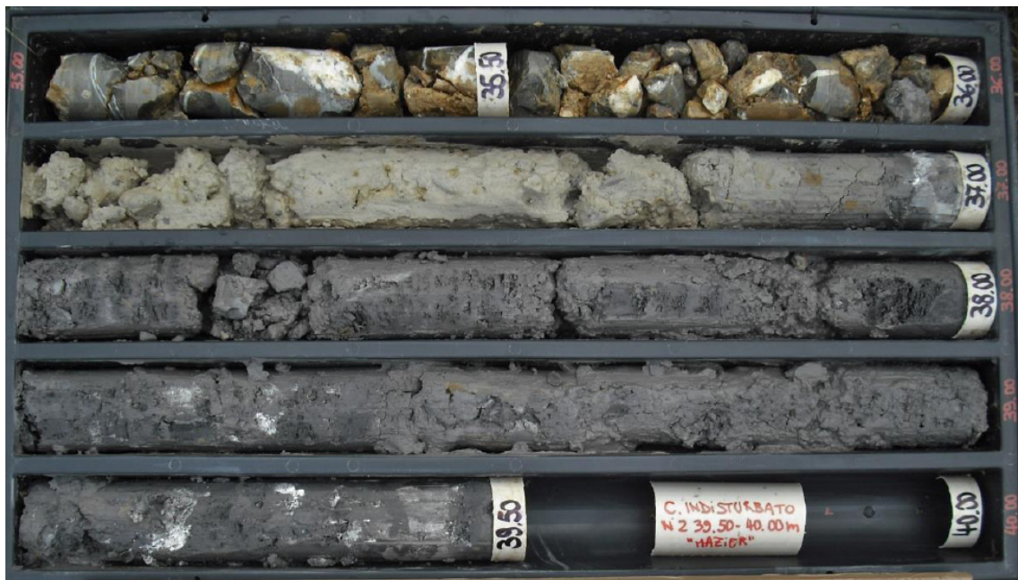
Fig. 70 – Argille e calcari di Canetolo (ACCa) in sondaggio (SD3bis 35 – 40 m)
