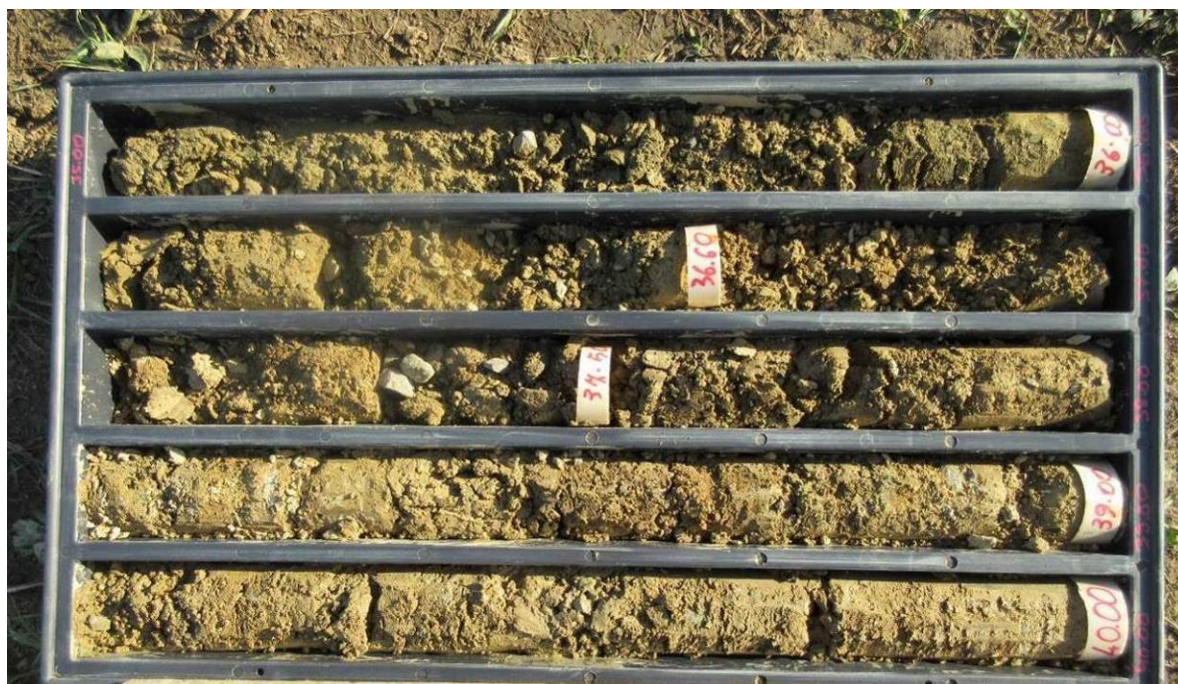
Figura 62 – Depositi fluviali (Qt1d) in sondaggio (5b-SD12 35–40 m)
