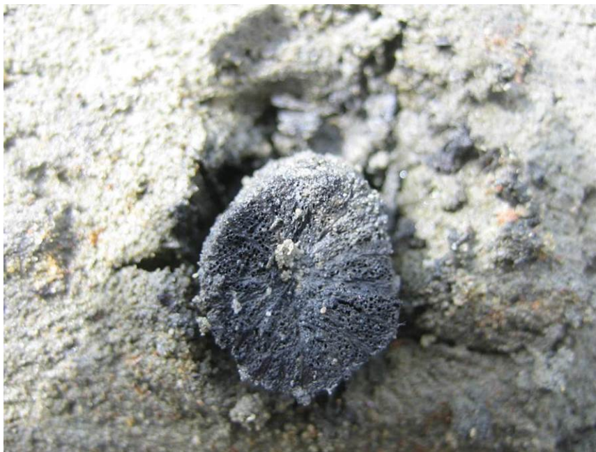
Fig. 52 – Depositi di spiaggia (H3c) in sondaggio (5b-SD18 / 11.30 m tronco fossile)
