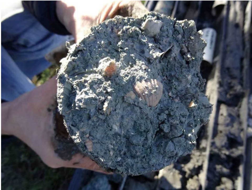
Fig. 46 – Depositi lagunari (H1a) in sondaggio (5b-SD31 14.0 m)
