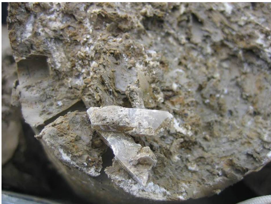
Fig. 43 – Depositi palustri (H1a1) in sondaggio (5b-SD15 /1.40 m)
