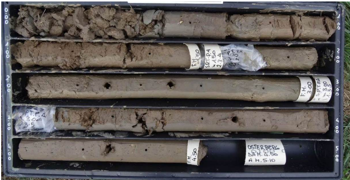
Fig. 41 – Depositi di ambiente fluviale (H1b) in sondaggio (5b-SD23 0-5 m)
