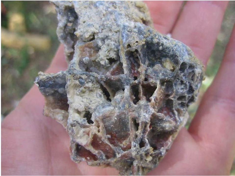
Fig. 76 – Calcare Cavernoso in sondaggio (SD37bis - "calcare a cellette")
