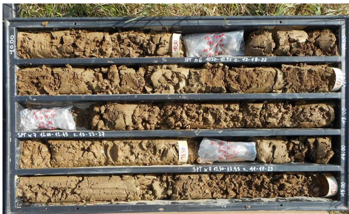
Fig. 59 – Depositi eolici (Qt1e) in sondaggio (5b-SD40 / 10-15 m)
