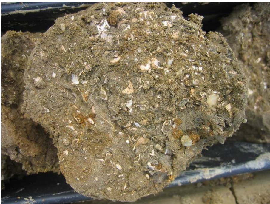
Fig. 49 – Depositi di spiaggia (H2) in sondaggio (5b-SD27 / 16.50 m)
