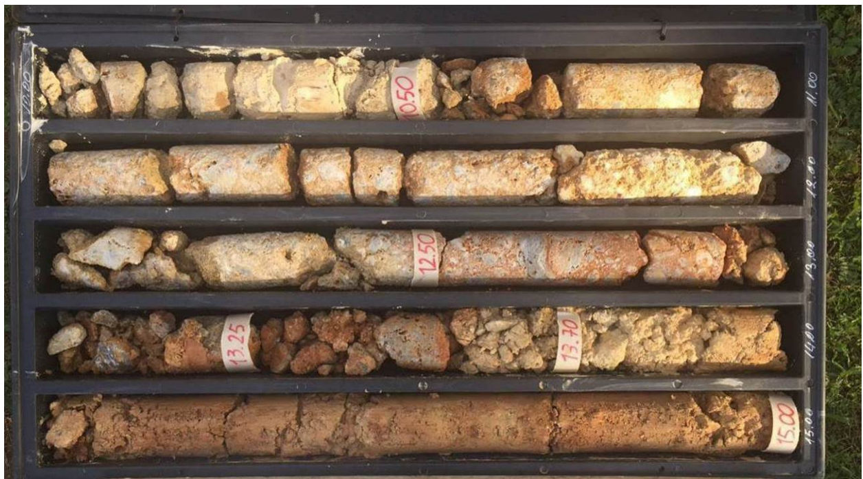
Fig. 80 – Calcare Cavernoso in sondaggio (SD8 10-15m in prossimità delle terme dell' Osa)
