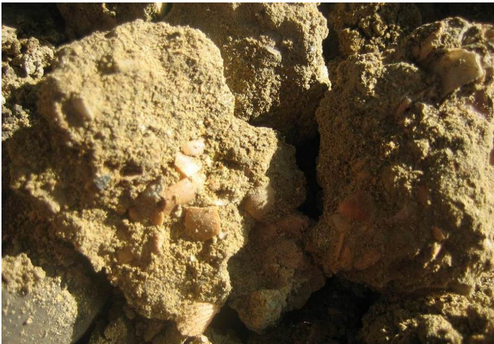
Fig. 48 – Depositi di spiaggia (H2) in sondaggio (5b-SD34bis 11.55-16.50 m)
