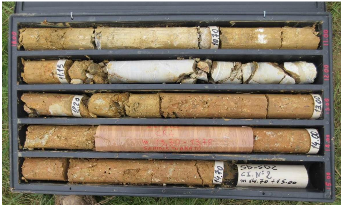
Fig. 68 – Argille e calcari di Canetolo (ACCa) in sondaggio (SD2 10 - 15 m)
