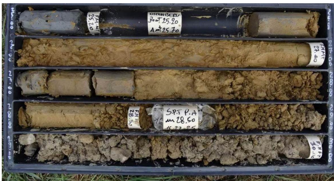
Figura 64 – Depositi Marino Costieri (Qt2) in sondaggio (5b-SD33 26–30 m)
