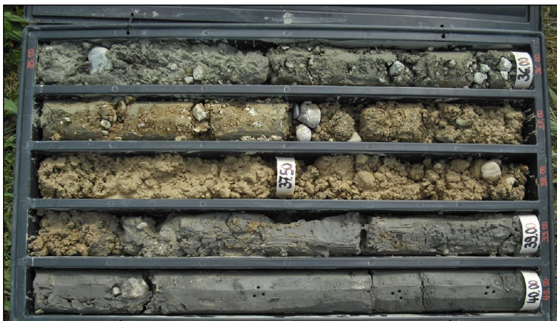
Fig. 56 – Depositi fluviali (Qt1j) in sondaggio (5b-SD22 35 / 39.20 m)
