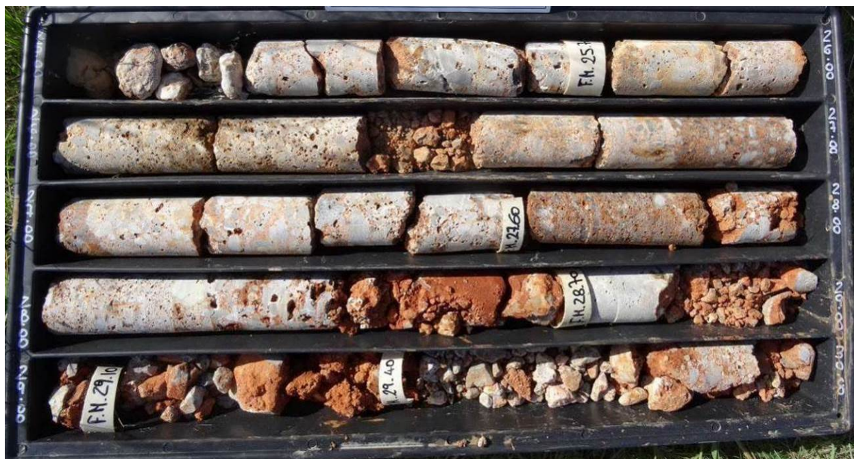
Fig. 78 – Calcare Cavernoso in sondaggio (SD36 25-30 m)
