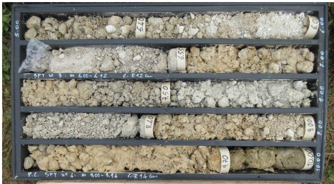
Figura 72 – Argille e calcari di Canetolo (ACCb) in sondaggio (SD6 5 - 10 m)
