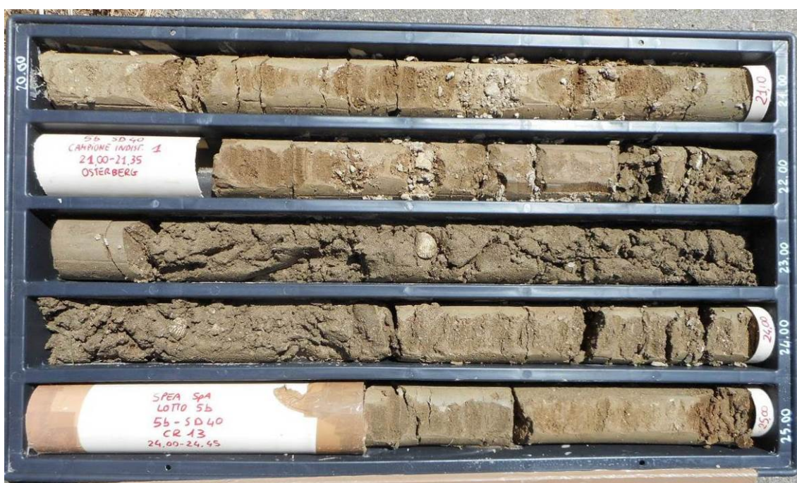
Figura 65 – Depositi Marino Costieri (Qt2) in sondaggio (5b-SD40 20-25 m)
