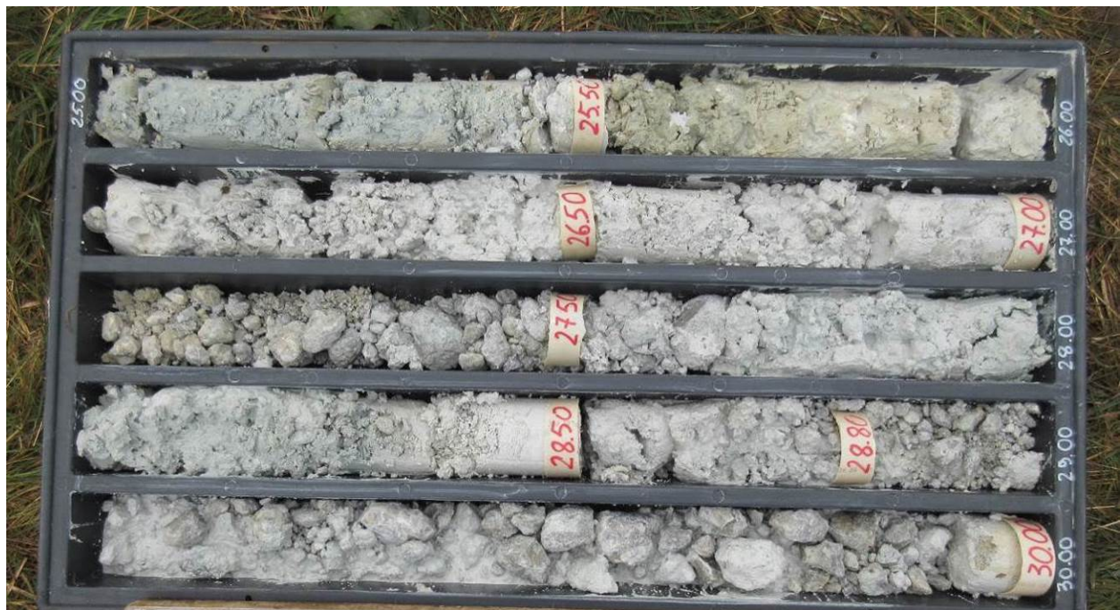
Fig. 82 – Calcare Cavernoso in sondaggio (SD9 25-30 m in prossimità delle terme dell' Osa)
