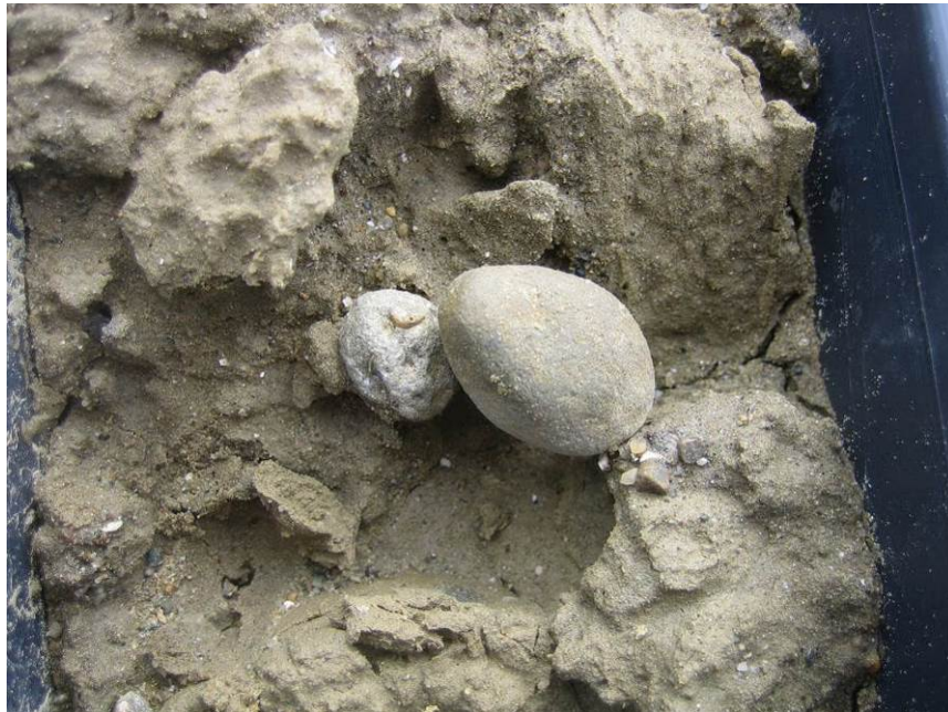
Fig. 51 – Depositi di spiaggia (H3c) in sondaggio (5b-SD15 m)
