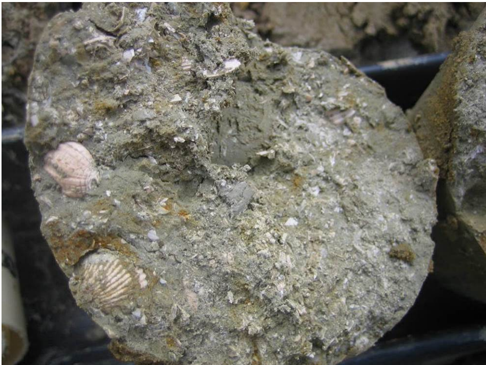
Fig. 45 – Depositi lagunari (H1a) in sondaggio (5b-SD27 / 13,70 m)
