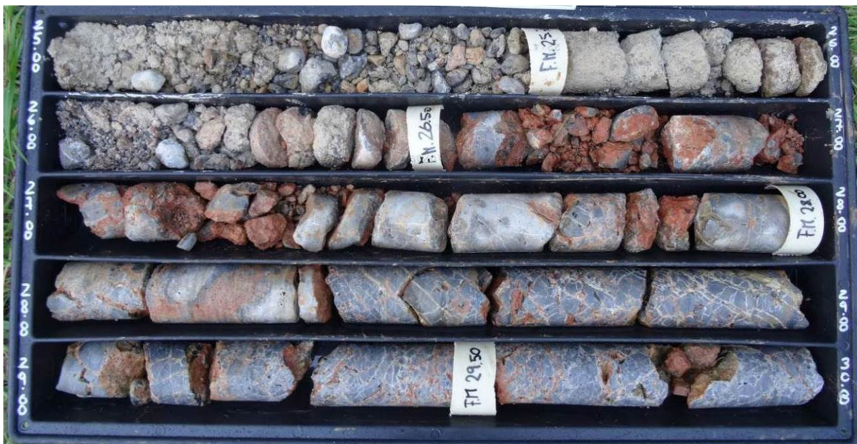
Fig. 77 – Calcare Cavernoso in sondaggio (SD34 bis 25-30 m)
