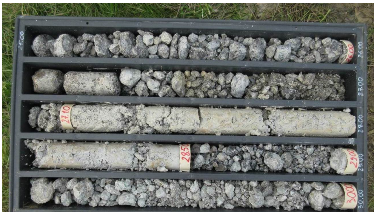
Fig. 83 – Calcare Cavernoso in sondaggio (SD10 25-30 m in prossimità delle terme dell' Osa)
