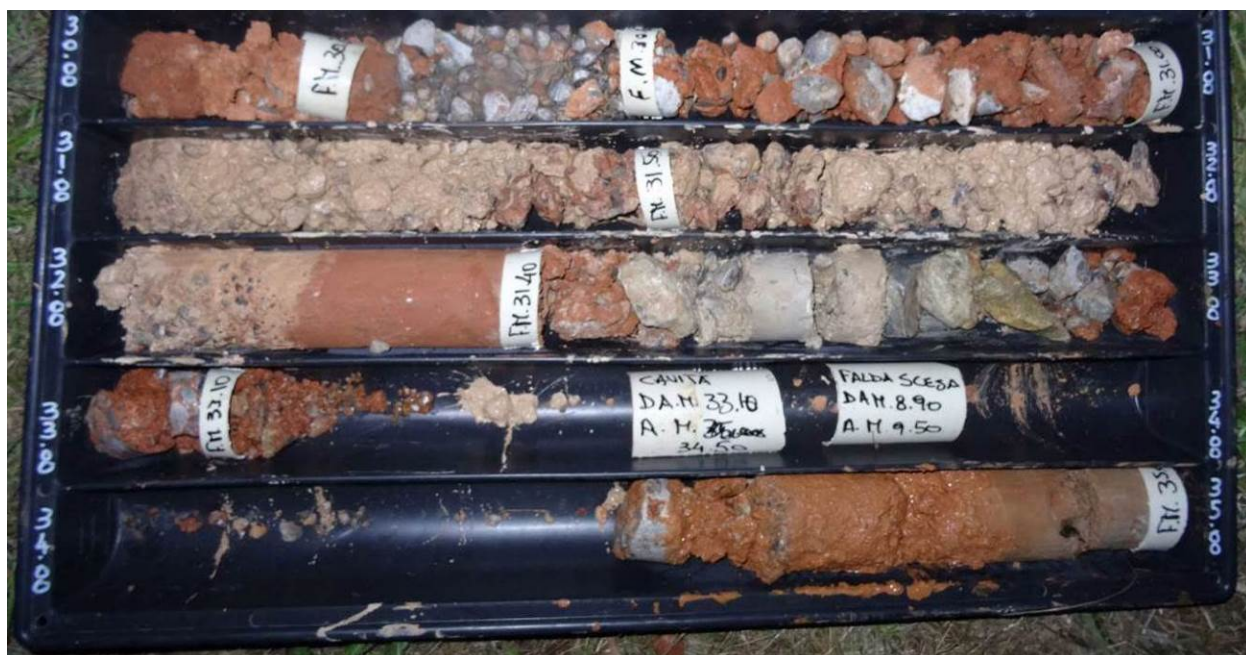
Fig. 79 – Calcare Cavernoso in sondaggio (SD36 30-35 m)
