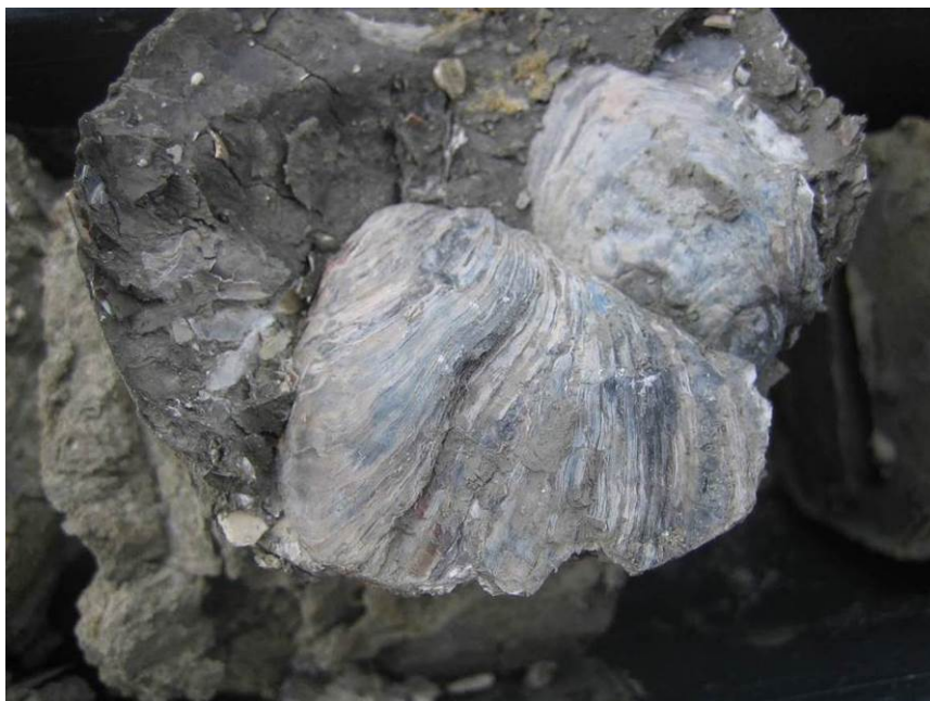
Fig. 57 – Depositi di piana costiere palustro lagunare (Qt1k) in sondaggio (5b-SD15 18.60 m)
