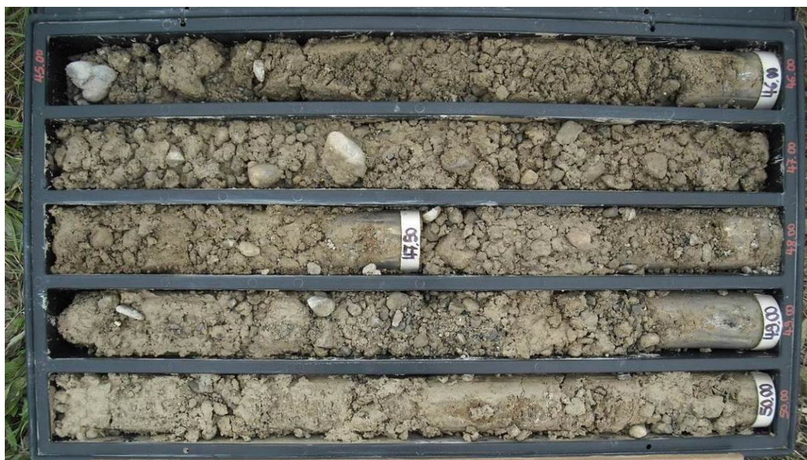
Figura 63 – Depositi fluviali (Qt1d) in sondaggio (5b-SD20 40-50 m)
