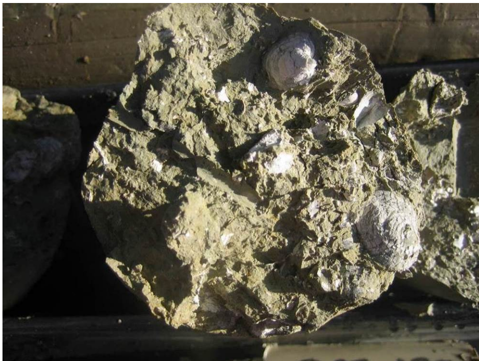
Fig. 47 – Depositi lagunari (H1a) in sondaggio (5b-SD33 11-13.50 m)
