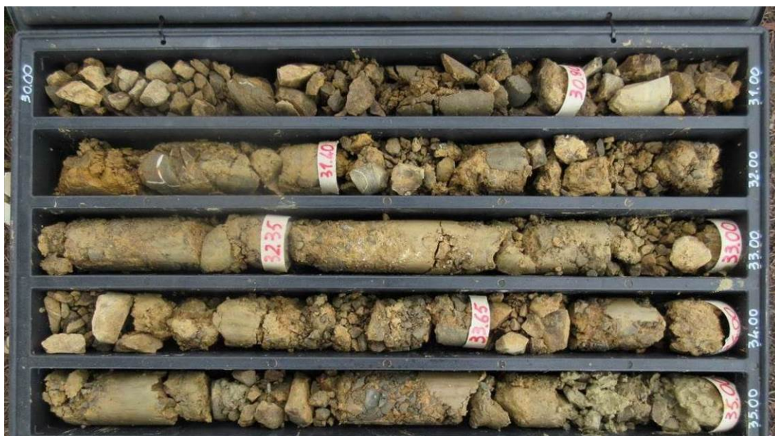
Fig. 67 – Argille e calcari di Canetolo (ACCa) in sondaggio (SD1 25 – 35 m)
