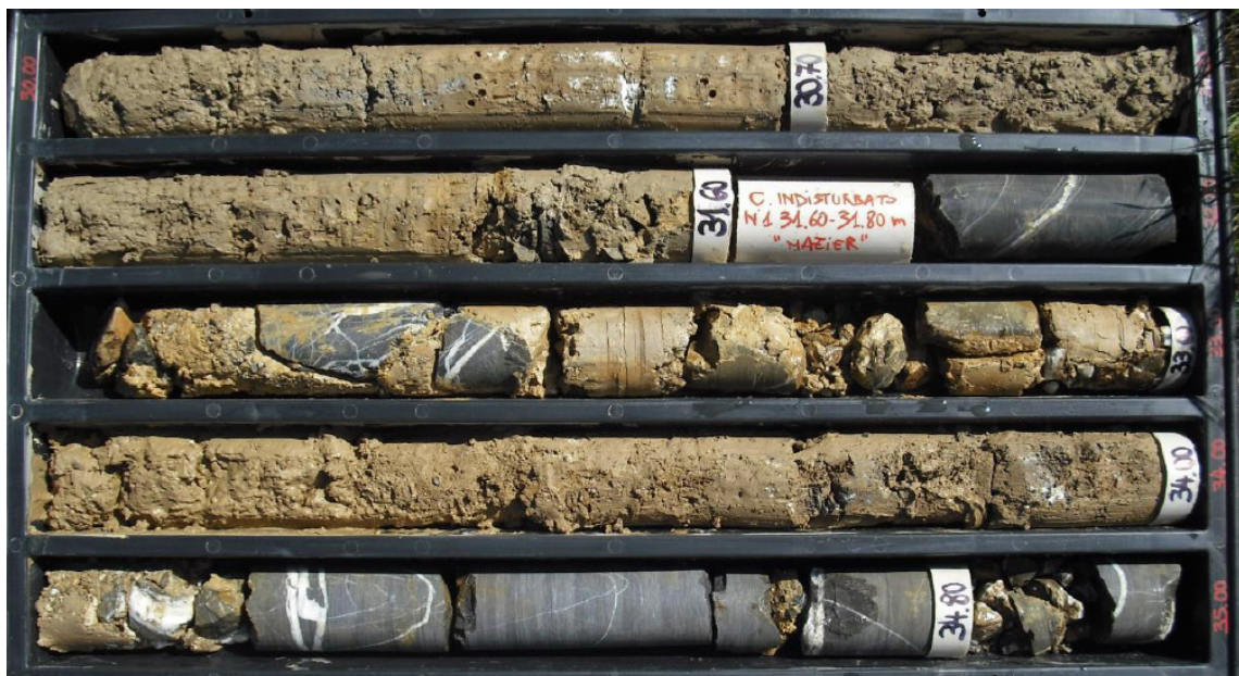
Fig. 68 – Argille e calcari di Canetolo (ACCa) in sondaggio (SD2 10 - 15 m)
