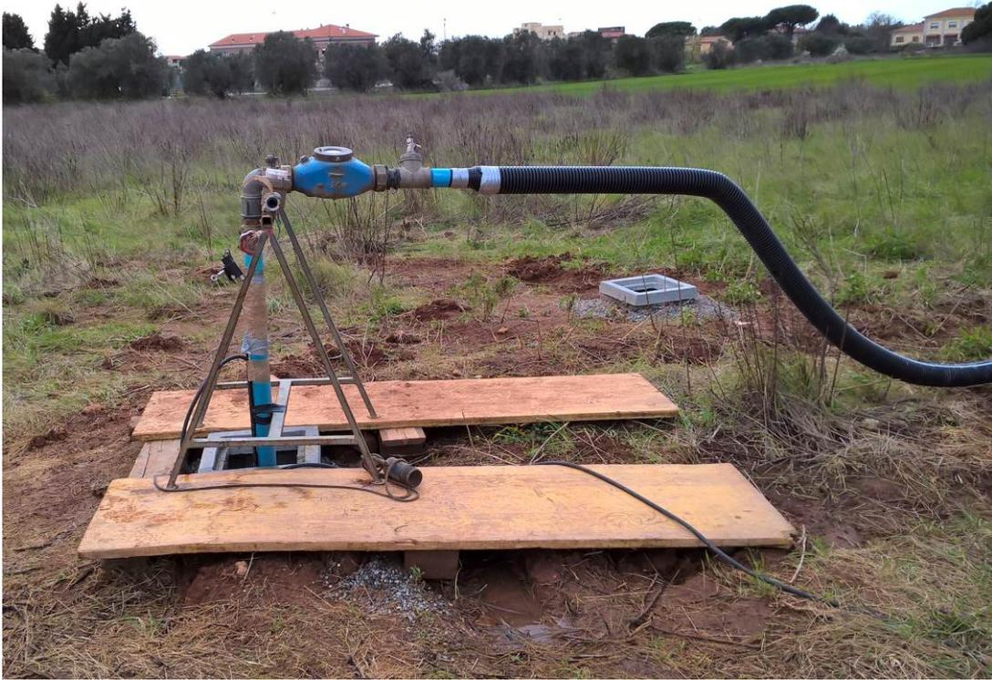
Figura 120 – Allestimento per la prova di emungimento di lunga durata (72 ore) sul pozzo 5b-P1; sul tubo di mandata è riconoscibile il contatore per il controllo della portata in emungimento.
