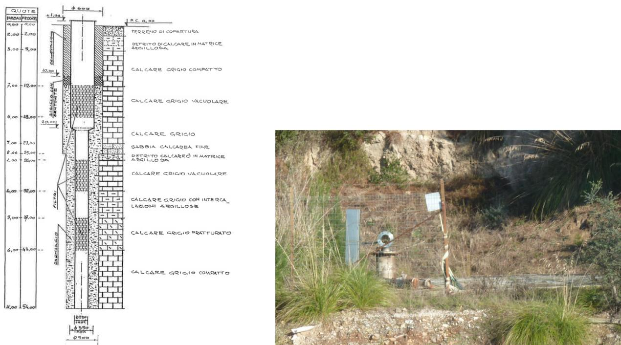
Figura 40 – Stratigrafia e schema del pozzo di captazione (a sinistra) delle Terme dell'Osa e immagine da lontano dell'opera di presa.
