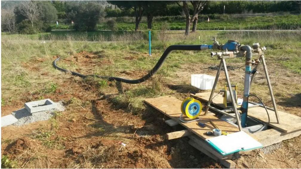
Figura 113 – Allestimento dell'impianto di pompaggio e della strumentazione di misura per la prova di emungimento a gradini sul pozzo P1.
