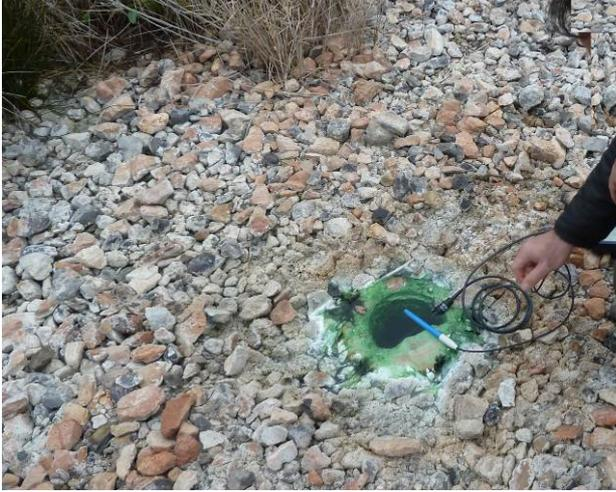
Figura 41 – Polla di risorgiva profonda caratterizzata da temperature elevate (30.4°) all'interno delle fondazioni di un palo che sosteneva una struttura non più esistente. Situazione al 21 gennaio 2016.
