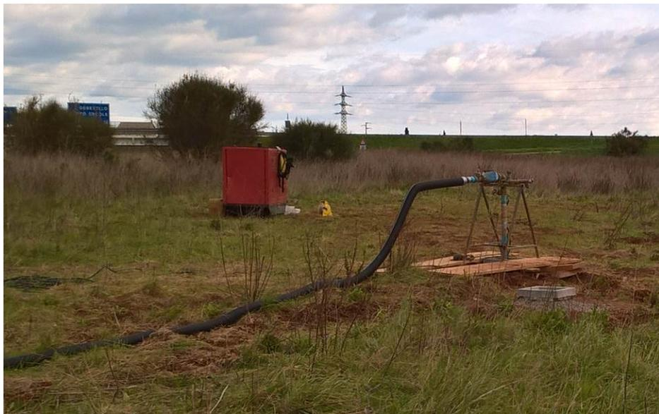
Figura 121 – Allestimento per la prova di emungimento di lunga durata (72 ore); gruppo elettrogeno per l'alimentazione dell'elettropompa sommersa.
