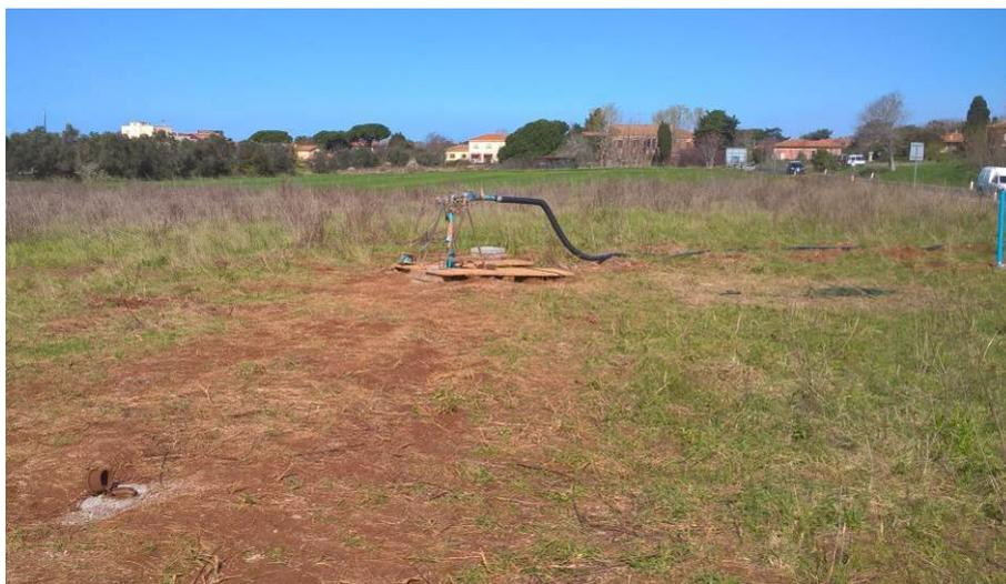
Figura 122 – Panoramica dell'area di indagine con il pozzo prova 5b-P1, dove è stato eseguito il pompaggio, quindi, in primo piano sulla sinistra, il piezometro 5b-SD36, mentre sulla destra è individuabile il piezometro 5b-Pz1 in corrispondenza del tubo in pvc azzurro.
