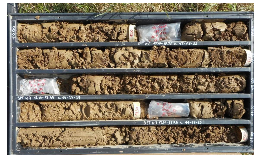
Depositi eolici (Qt1e) in sondaggio (5b-SD40 / 10-15 m)
