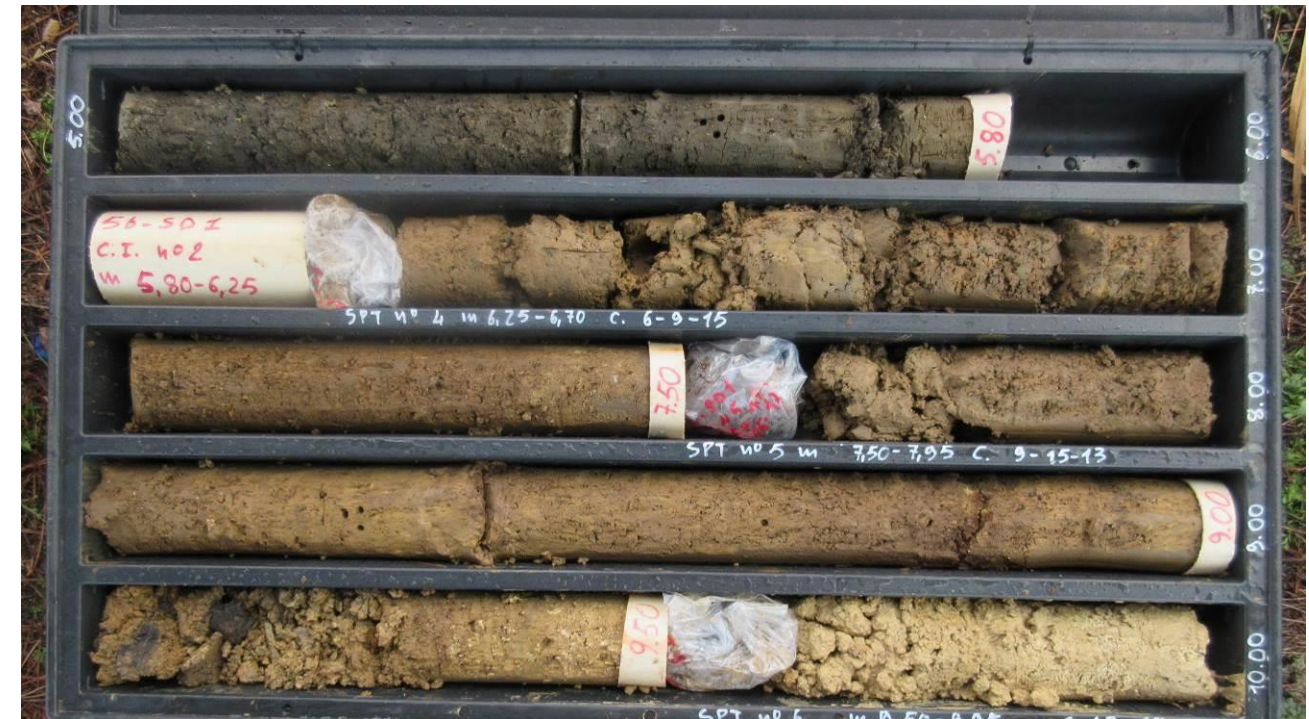
Depositi di versante (a3) in sondaggio (5b-SD1 5-10 m)
