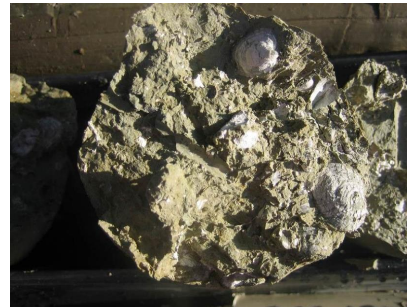
Depositi lagunari (H1a) in sondaggio (5b-SD33 11-13.50 m)
