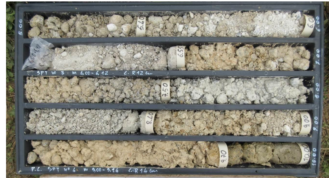
Argille e calcari di Canetolo (ACCb) in sondaggio (SD6 5 - 10 m)
