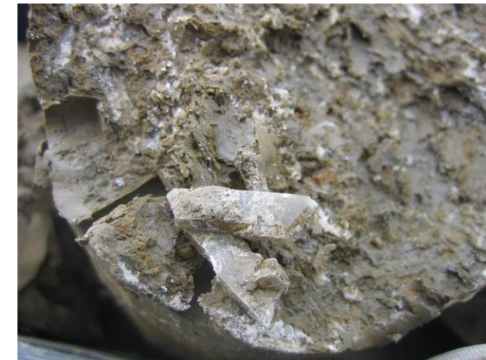
Depositi palustri (H1a1) in sondaggio (5b-SD15 /1.40 m)
