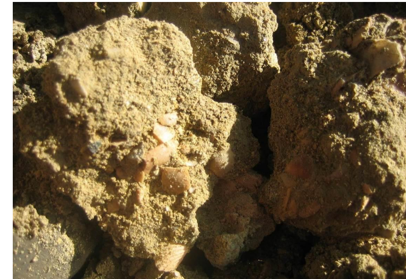
Depositi di spiaggia (H2) in sondaggio (5b-SD34bis 11.55-16.50 m)
