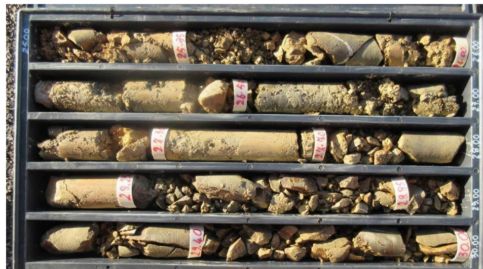
Argille e calcari di Canetolo (ACCa) in sondaggio (SD1 25 – 30 m)
