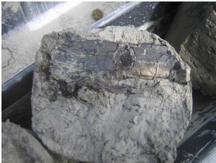
Depositi lagunari (H1a) in sondaggio (5b-SD27 / 10,40 m)
