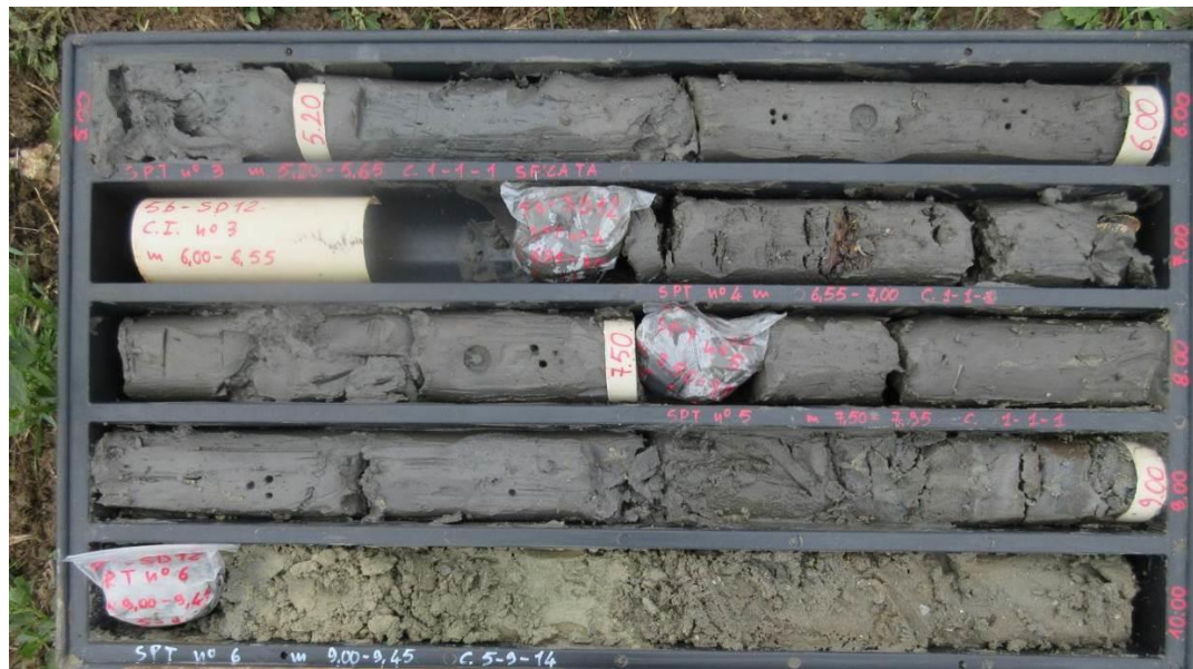
Depositi lagunari (H1a) in sondaggio (5b-SD12 / 5-9 m)
