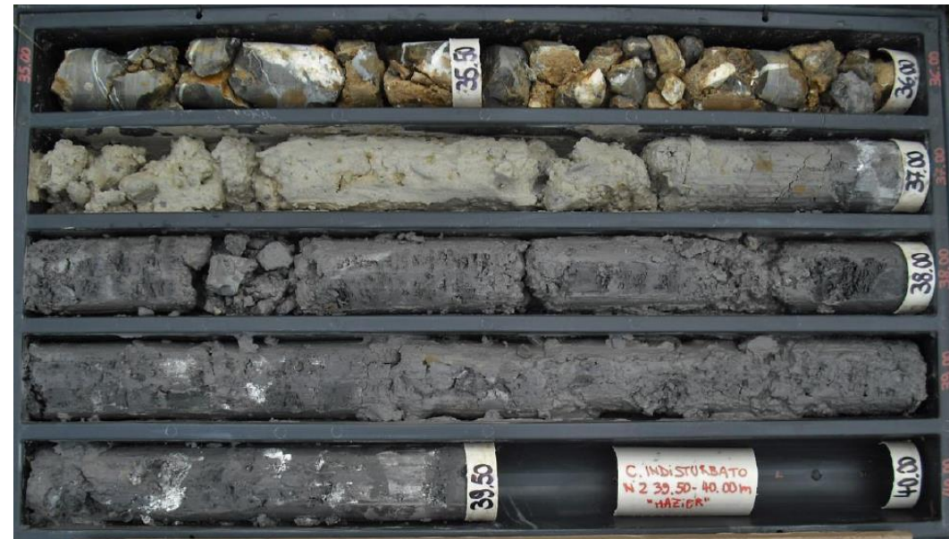
Argille e calcari di Canetolo (ACCa) in sondaggio (SD3bis 30 – 40 m)
