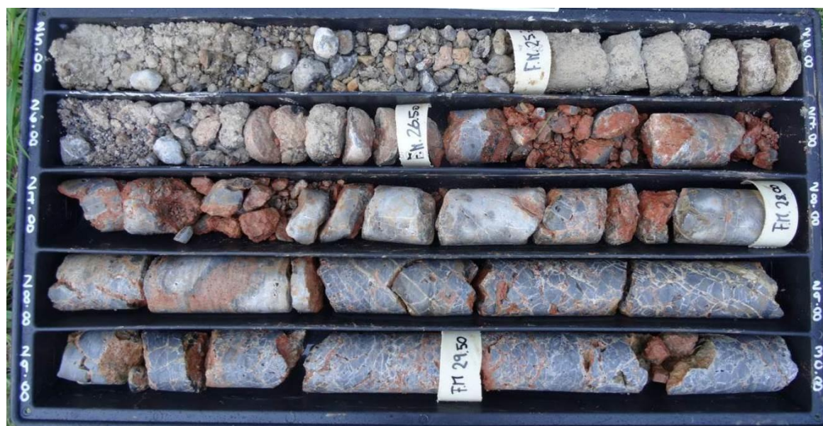
Calcare Cavernoso in sondaggio (SD34 bis 25-30 m)
