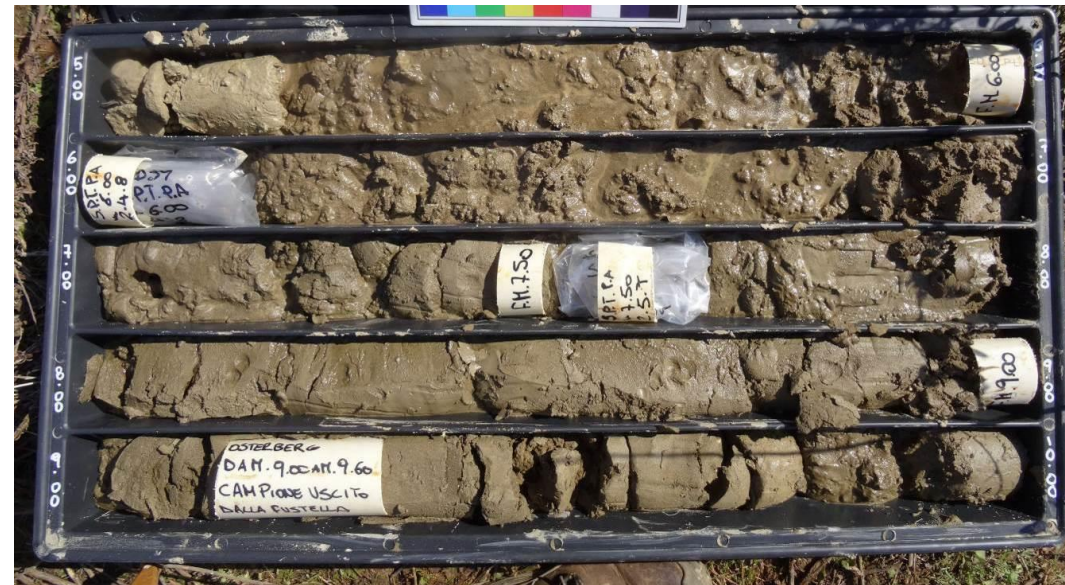
Depositi di spiaggia (H2) in sondaggio (5b-SD39 / 5-10 m)
