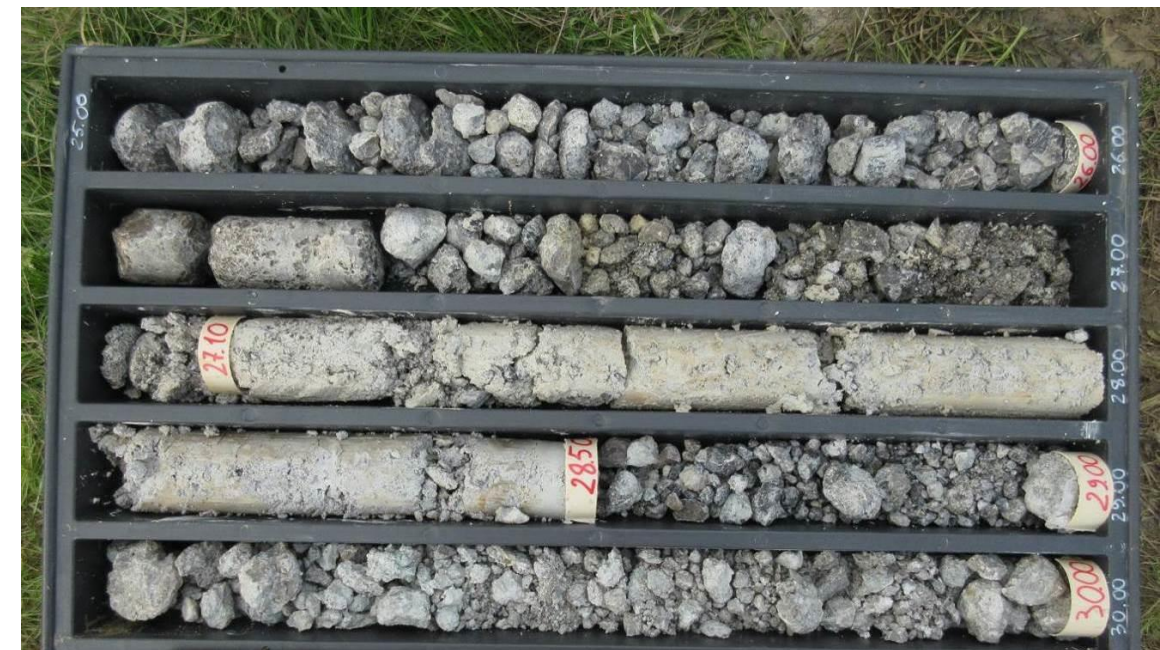
Calcare Cavernoso in sondaggio (SD10 25-30 m in prossimità delle terme dell' Osa)
