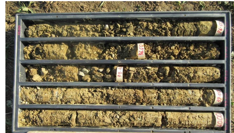
Depositi fluviali (Qt1d) in sondaggio (5b-SD12 35–40 m)
