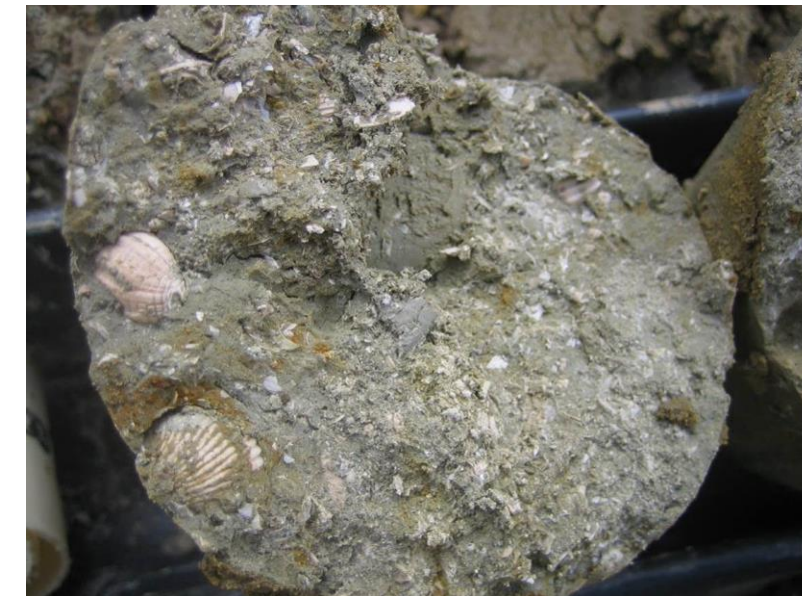
Depositi lagunari (H1a) in sondaggio (5b-SD27 / 13,70 m)
