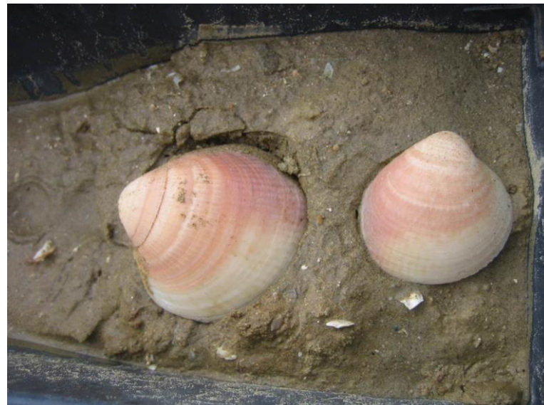
Depositi di spiaggia (H3c) in sondaggio (5b-SD15 / 11.0 m)
