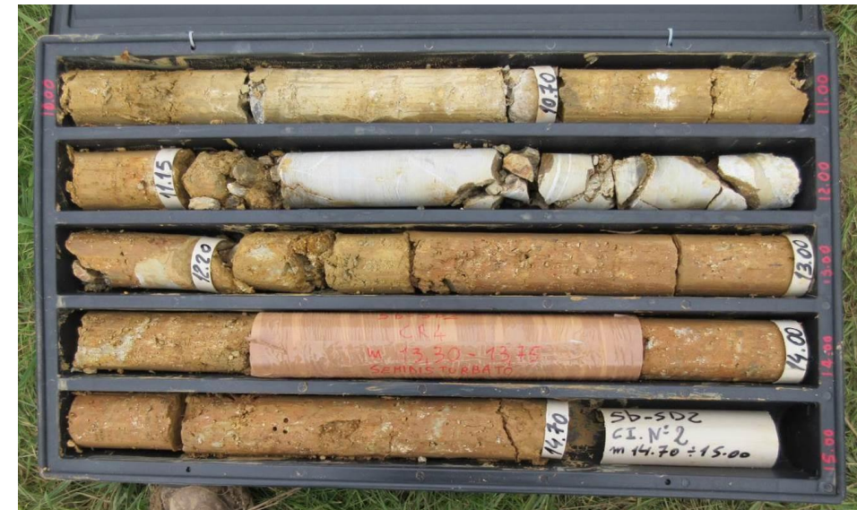
Argille e calcari di Canetolo (ACCa) in sondaggio (SD2 10 - 15 m)
