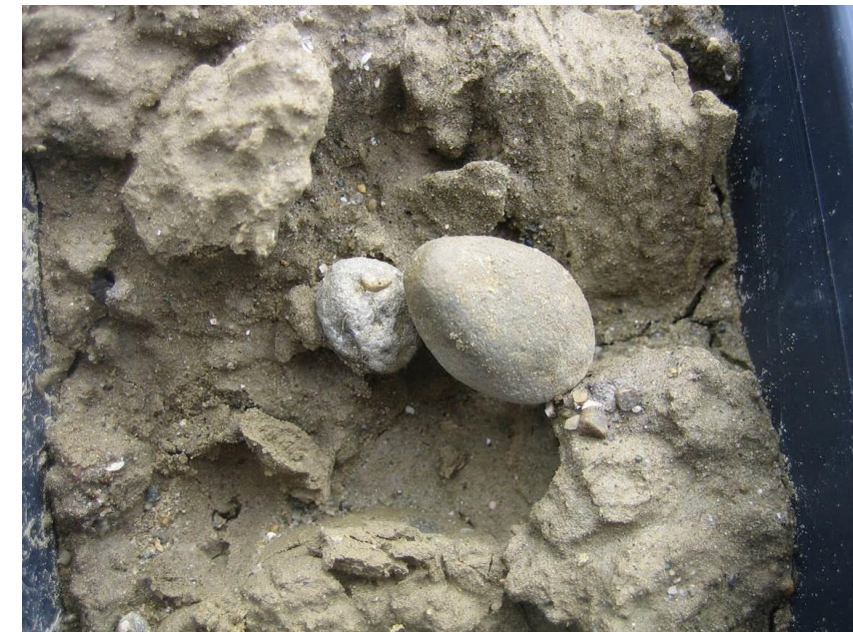
Figura 20 – Depositi di spiaggia (H3c) in sondaggio (5b-SD15 m)
