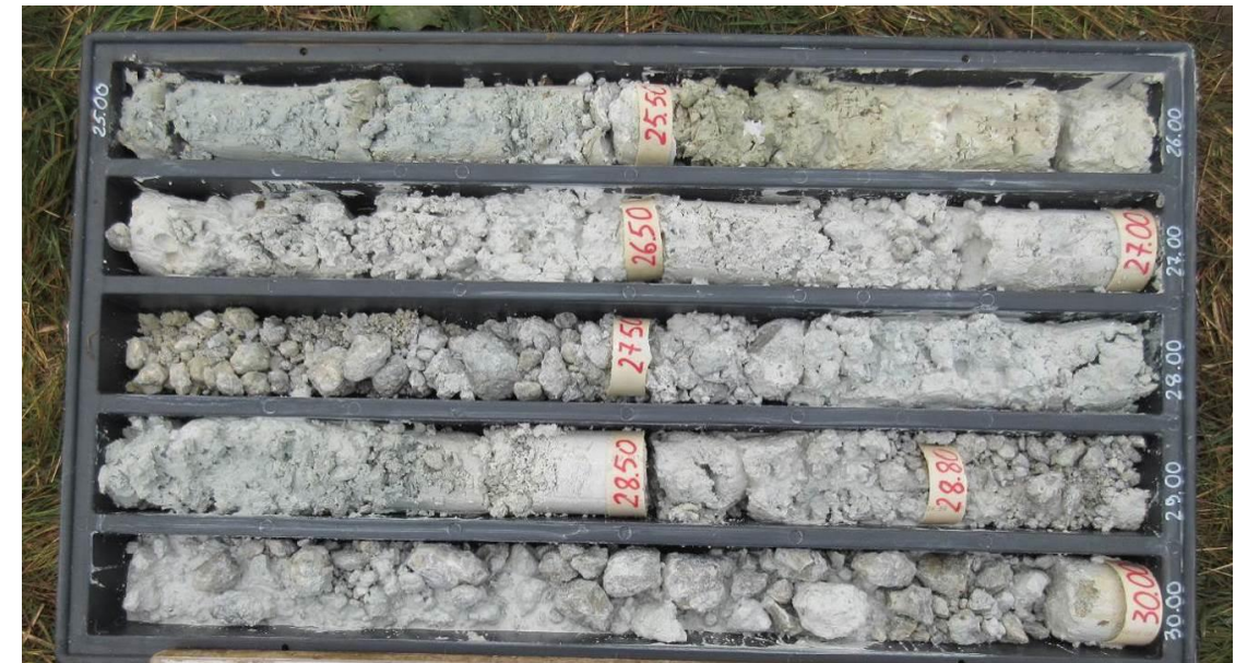
Calcare Cavernoso in sondaggio (SD9 25-30 m in prossimità delle terme dell' Osa)
