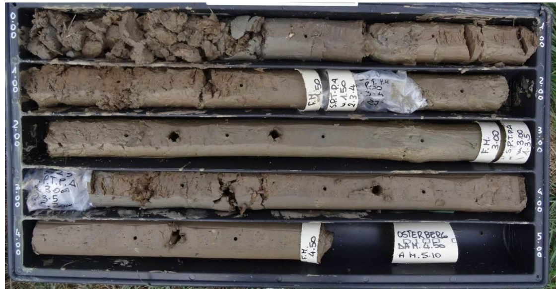
Depositi di ambiente fluviale (H1b) in sondaggio (5b-SD23 0-5 m)
