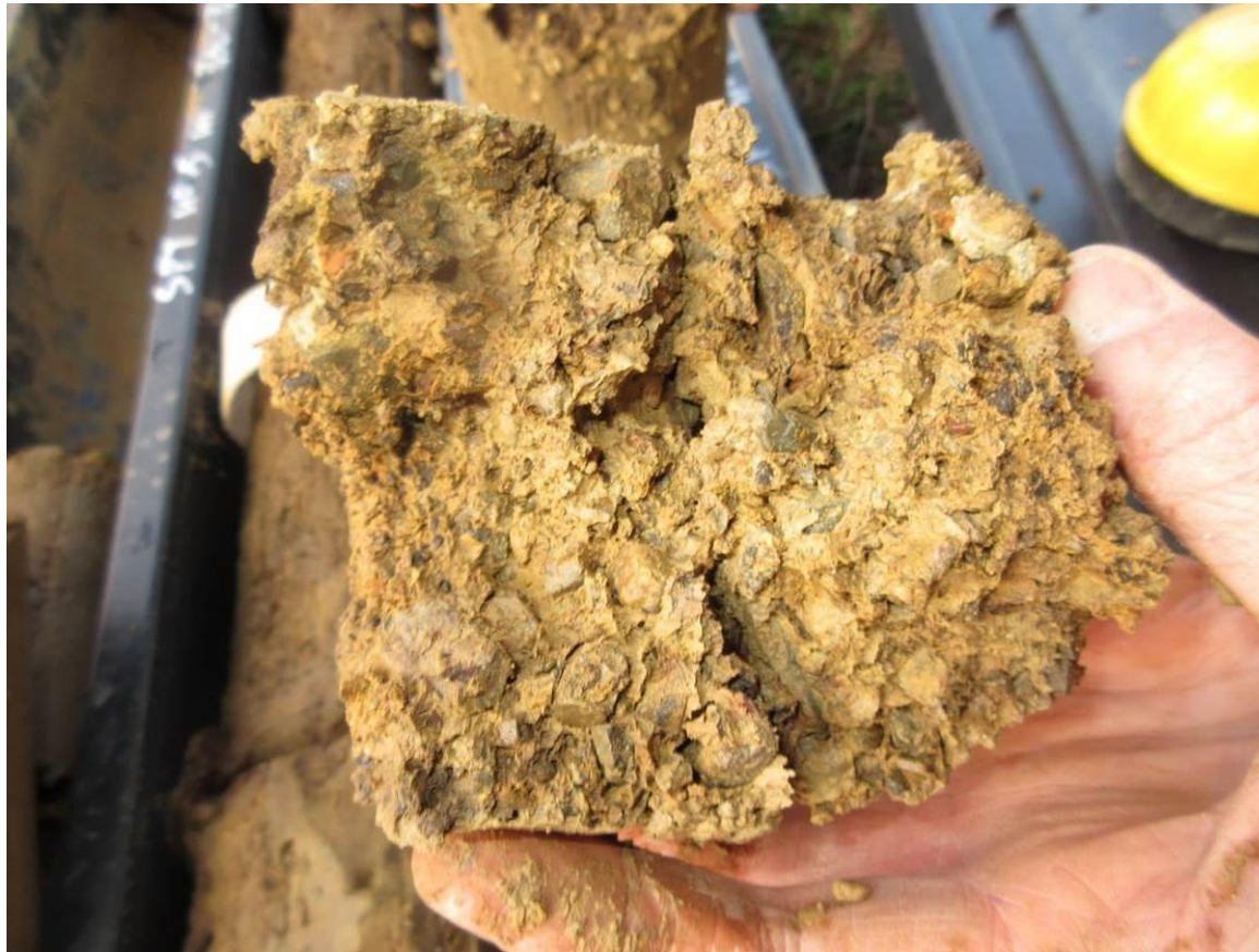
Depositi di versante (a3) in sondaggio (5b-SD1)
