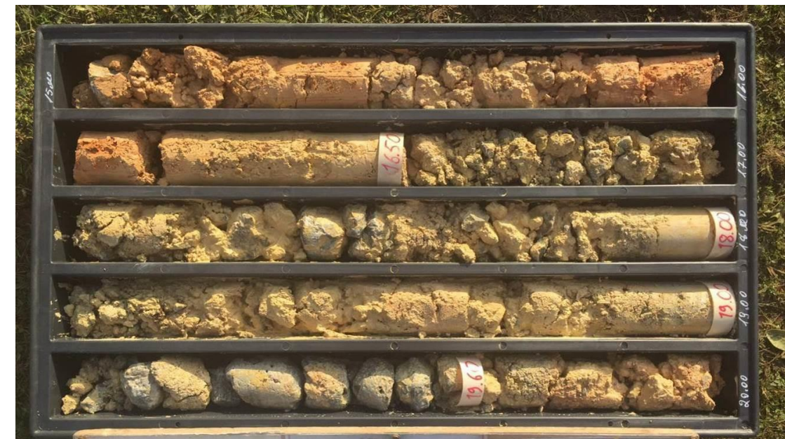
Calcare Cavernoso in sondaggio (SD8 10-15m e 15-20 m in prossimità delle terme dell' Osa)
