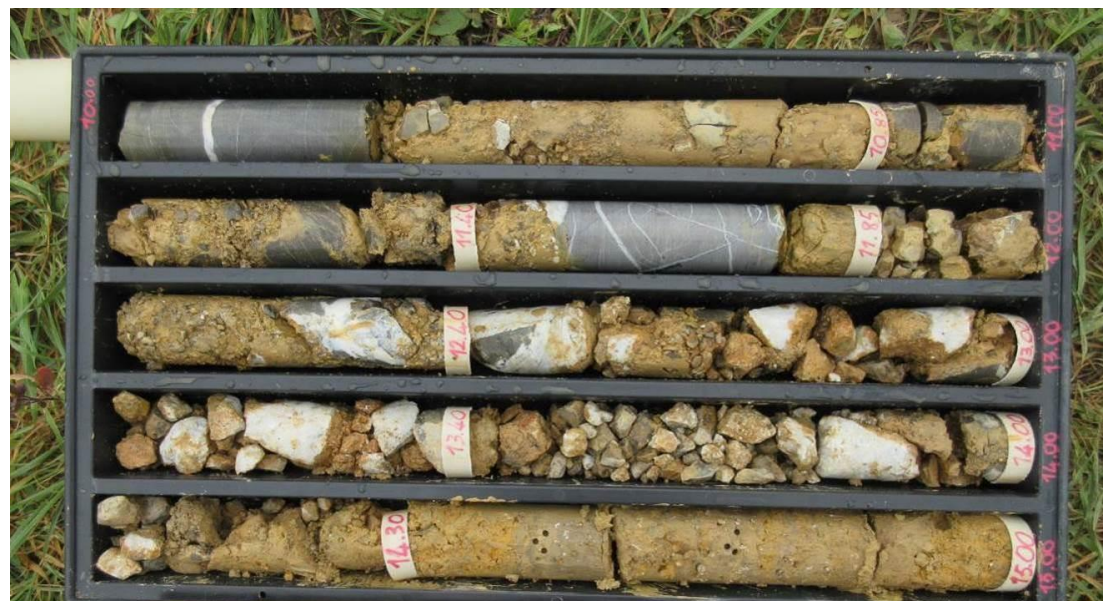
Argille e calcari di Canetolo (ACCa) in sondaggio (SD4 10 - 15 m)
