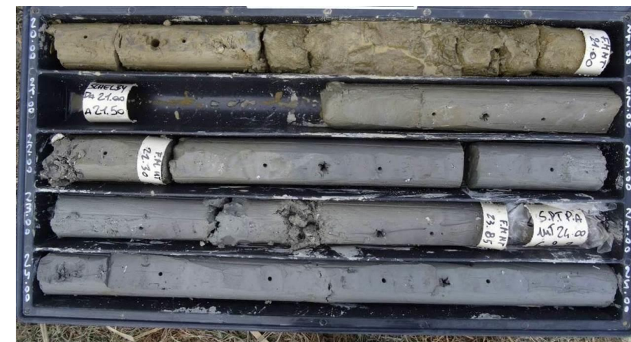
Depositi lagunari (H3a) in sondaggio (5b-SD33 / 21-25 m)
