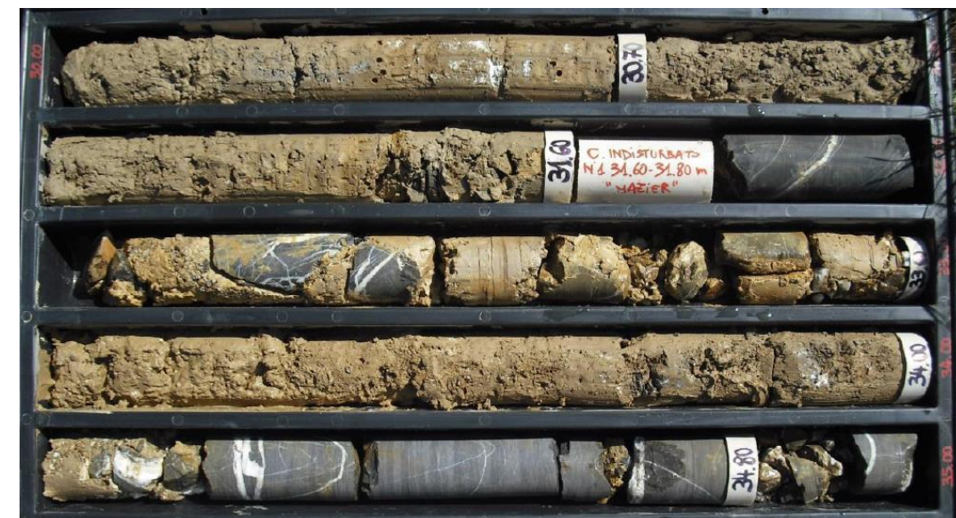
Argille e calcari di Canetolo (ACCa) in sondaggio (SD2 10 - 15 m)
