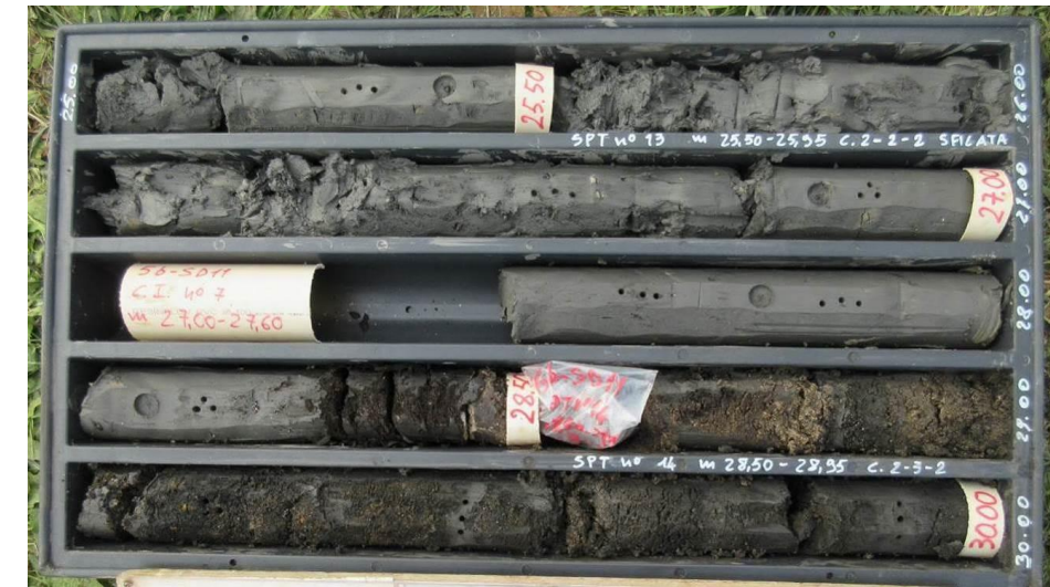
Depositi di piana costiera palustro lagunare (Qt1k) in sondaggio (5b-SD11 25-30 m).
