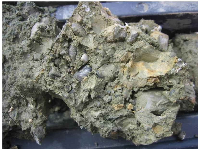
Depositi fluviali (Qt1d) in sondaggio (5b-SD12 34.50 m)
