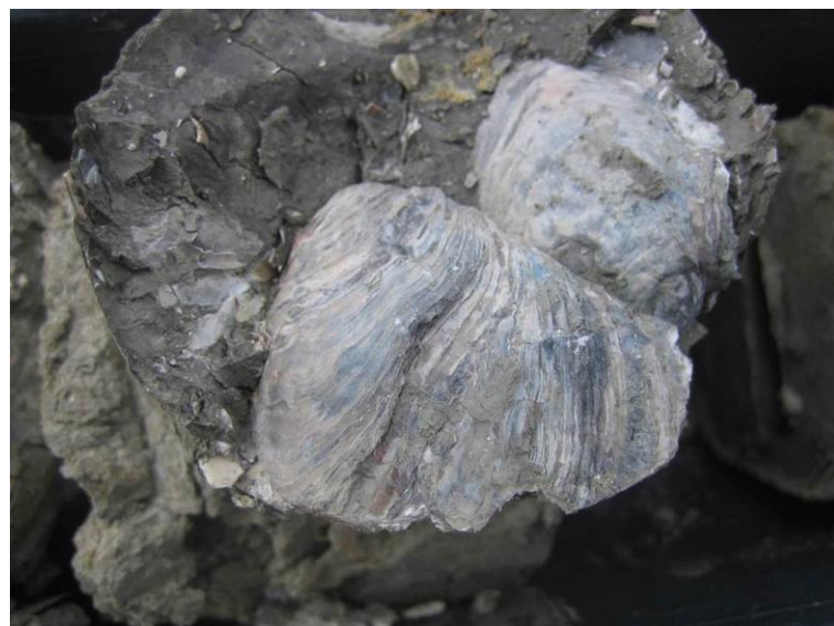
Depositi di piana costiera palustro lagunare (Qt1k) in sondaggio (5b-SD15 18.60 m)
