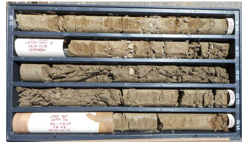
Depositi Marino Costieri (Qt2) in sondaggio (5b-SD40 20-25 m)
