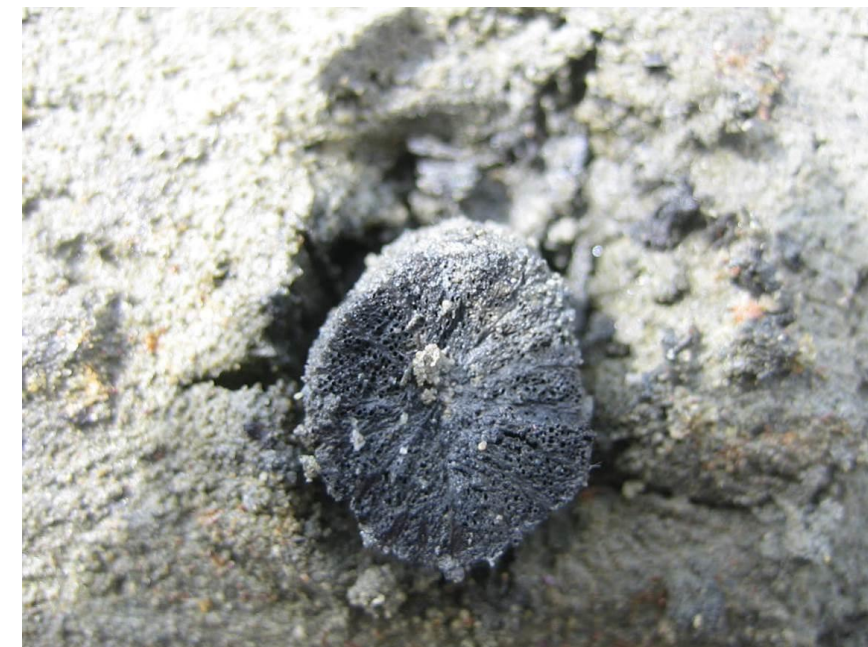
Depositi di spiaggia (H3c) in sondaggio (5b-SD18 / 11.30 m tronco fossile)
