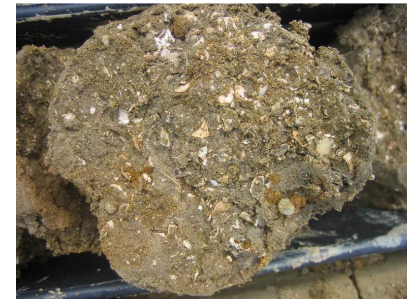
Depositi di spiaggia (H2) in sondaggio (5b-SD27 / 16.50 m)
