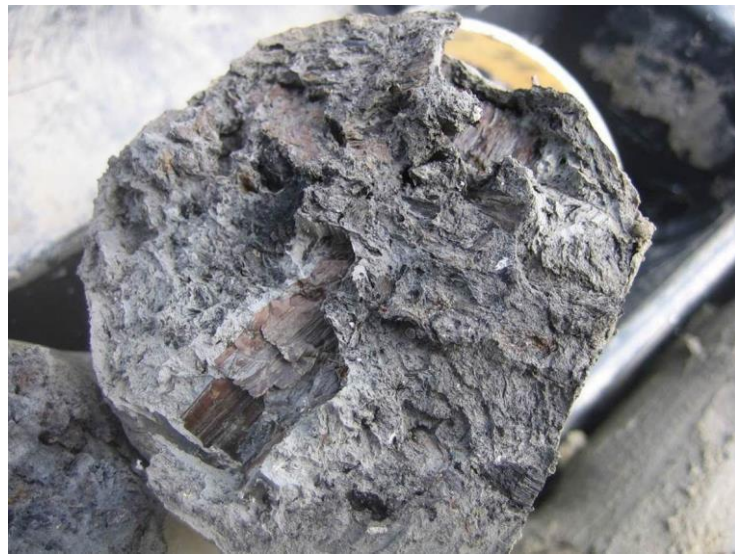
Depositi lagunari (H1a) in sondaggio (5b-SD24 / 9 m)
