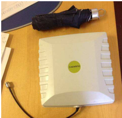
L'antenna RFid lettore dei Tag RFid localizzati sulle biciclette
