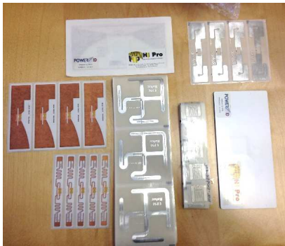
Diverse tipologie di Tag RFid utilizzati per verificare il funzionamento del sistema
