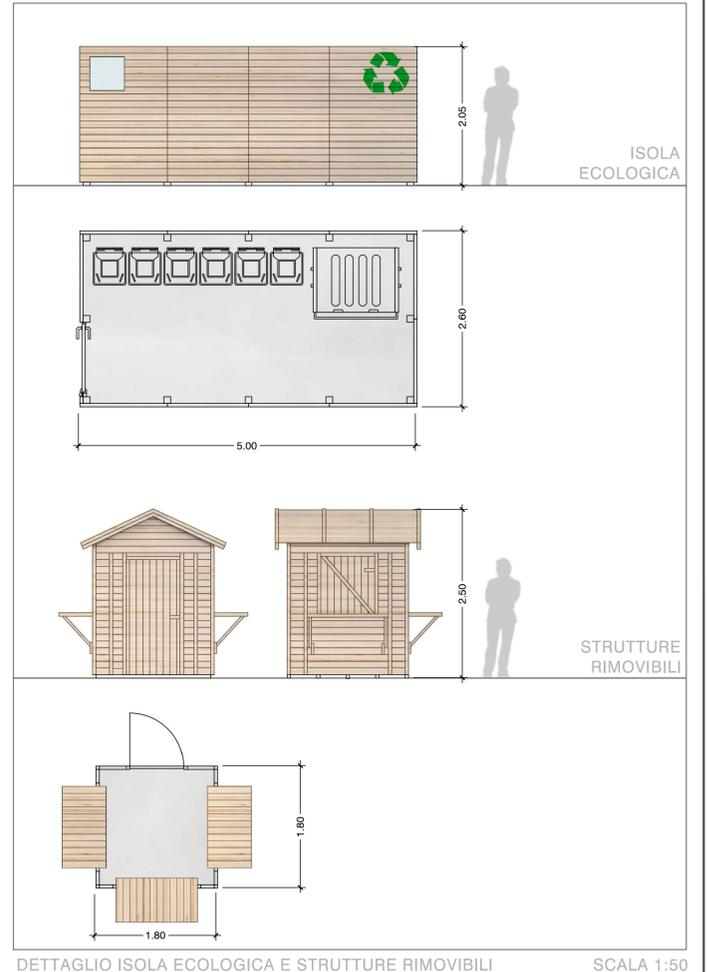
DETTAGLIO ISOLA ECOLOGICA E STRUTTURE RIMOVIBILI
