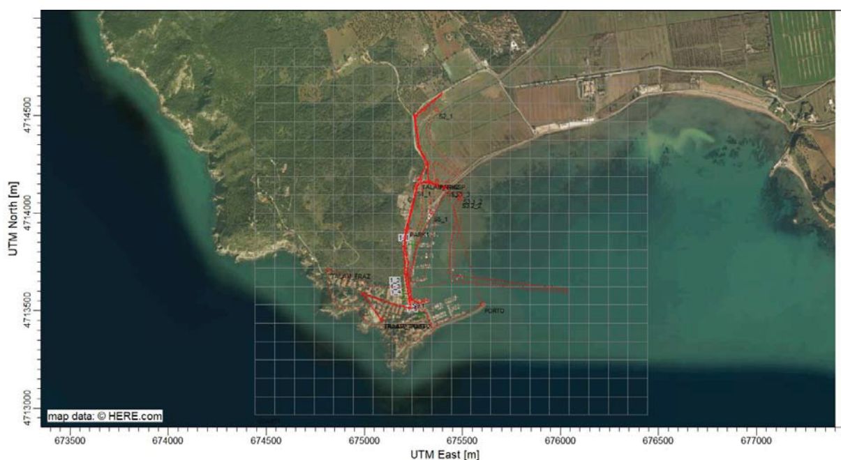
Figura 72 Schema dei recettori , in griglia e discreti, impiegati nelle simulazioni di dispersione, in rosso le sorgenti areali e lineari
