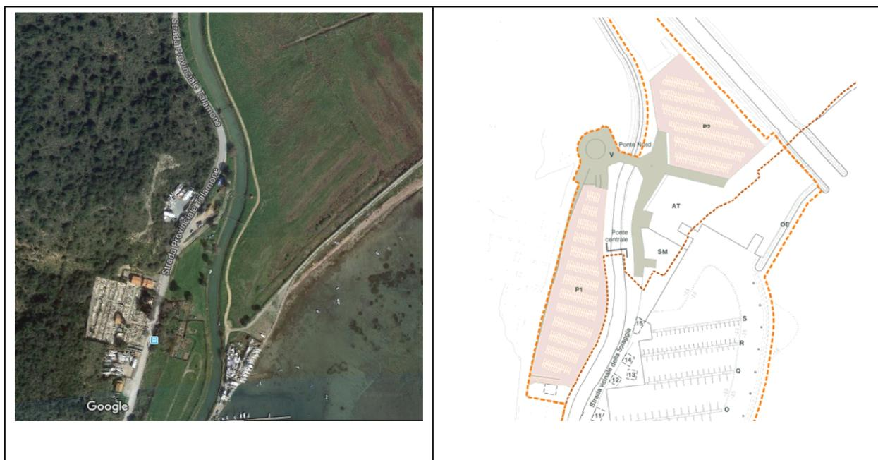
Le due **aree a parcheggio (P1 e P2)** del porto turistico di Talamone previste dal PRP sono entrambe ubicate nell'estremità settentrionale dello stesso e misurano 21.058. L'area P1 misura 11.482 m<sup>2</sup> e può contenere circa 316 posti auto; l'area P.2 misura 9.576 m<sup>2</sup> e contiene 325 posti auto.
